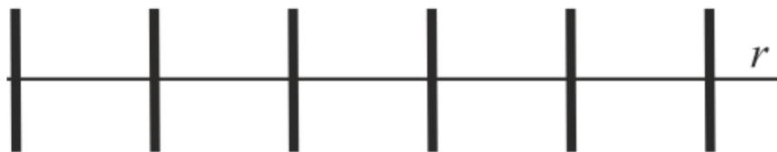
Рис. 2.1. Квазіодновимірна модель органічного кристалу ТТФ-типу. Жирні вертикальні відрізки прямих зображують проєкцію молекул вздовж великої осі. Літерою r позначено відстань вздовж стоса.
